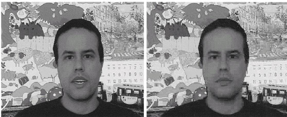
Figura 5.6. Cadru cu watermark dintr-o secvență video randată folosind (a) un model 3-D al capului și parametrii de animație și (b) un cadru similar după compresie video MPEG-2 la 600 kbit/s
