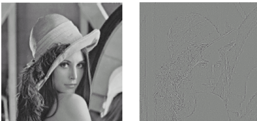
(a) Imagine cu watermark ( k mare) (b) Diferența W(x, y) = I(x, y) - I_w(x, y)
